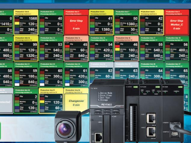
製造現場における、IoTシステムとして活用いただけます。現場の情報を収集することで、**設備の稼働情報、異常信号や、NG要因、測定数値などトレーサビリティデータの収集をすることが可能**です。稼働管理以外にも、各種センサーを取り付けることで、消費電力管理、温湿度管理、流量・水圧管理と様々な情報を管理することができます。
